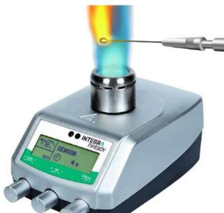
**Fieboy есо – это газовые горелки Бунзена для нагрева в открытом пламени. Газ в устройства подаётся из портативных баллончиков. Защитная система при затухании пламени, пытается его восстановить, но если это не происходит автоматически отключает подачу газа.**
